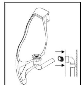
5.-Marque los puntos de fijación por la parte baja, asegurando que el tubo tenga una leve inclinación para que escurran los líquidos hacia la tubería del drenaje, retire de nuevo el mingitorio, perforo , coloque taquetes.
