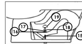
5.-Marque la altura sobre la pared, en donde vaya a perforar y colocar los taquetes e instale el tanque, coloque las piezas que conectaran la descarga entre el tanque y la taza como se muestra en la figura inicial (A-G)
