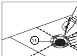
3.- Coloque el Inodoro haciendo pasar las pijas(15) por los orificios de la base de la taza, presione hacia abajo para conectarlo con la brida o cuello de cera y haga movimientos rotatorios para asegurarse que la taza quedo bien sentada sobre la superficie.
